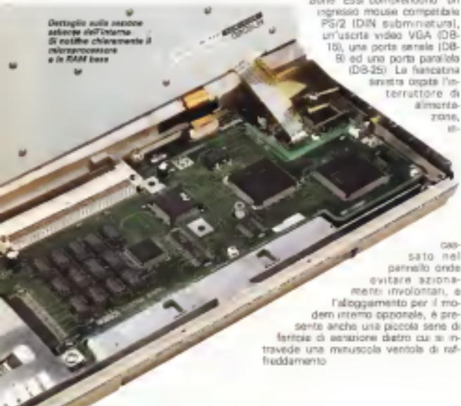
Dettaglio sulla sezione superiore dell'interno di notare chiaramente il microprocessore e la RAM base
